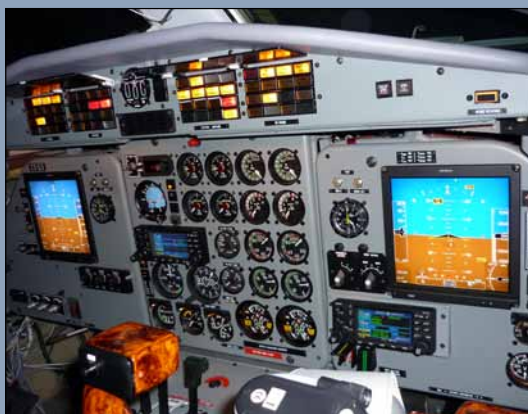
Přístrojové desky prototypu XL-410 (vlevo) a nejnovějšího L-410UVP-E20 se zobrazením EFIS
